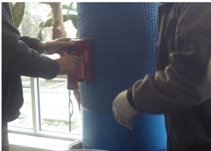
17 paveikslas. Kolonos armavimo tyrimas HILTI skeneriu
